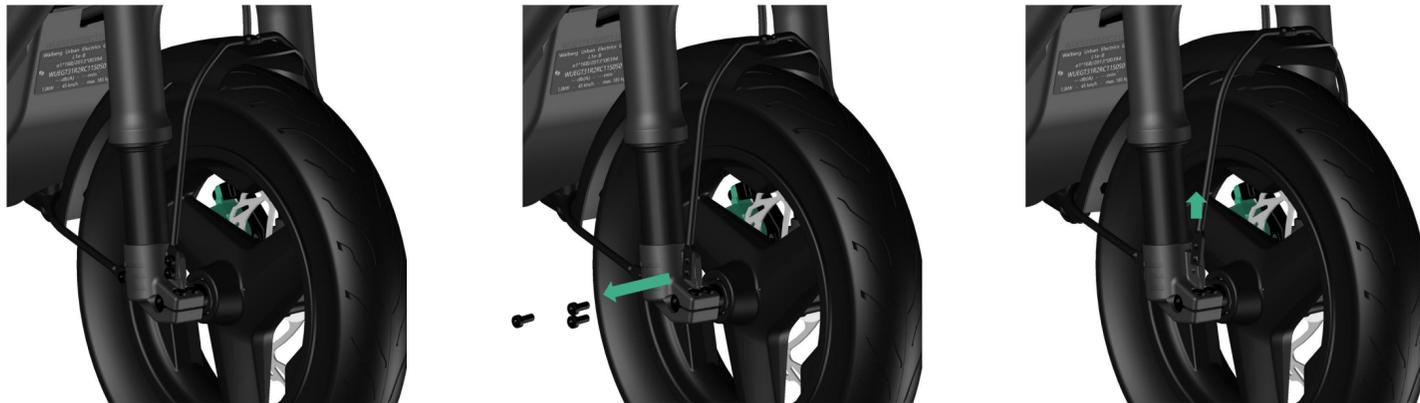
1. Damit du das Vorderrad komplett entnehmen kannst, musst du den rechten Schutzblechbügel entfernen (siehe Bild 1).
