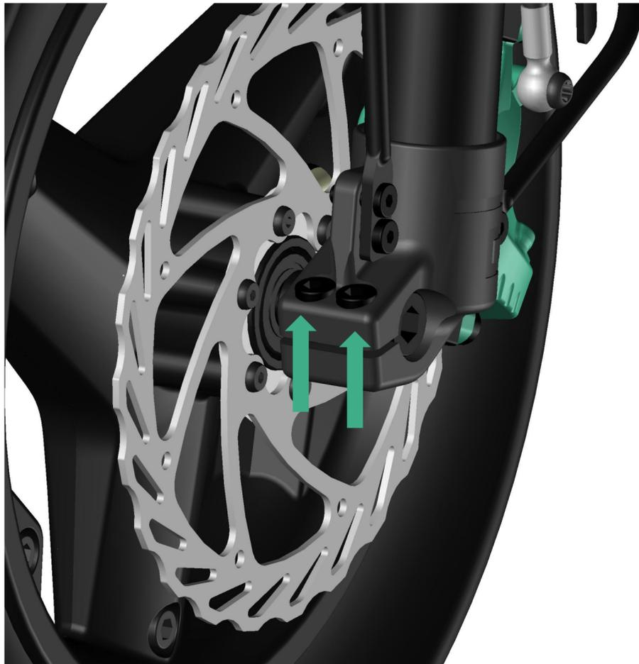
Im nächsten Schritt muss das Vorderrad demontiert werden.
