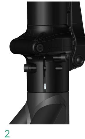
1. Lockere die beiden Klemmschrauben (H 6), die das Lenkrohr am Federgabelrohr befestigen (siehe Bild 1 und Bild 2).
