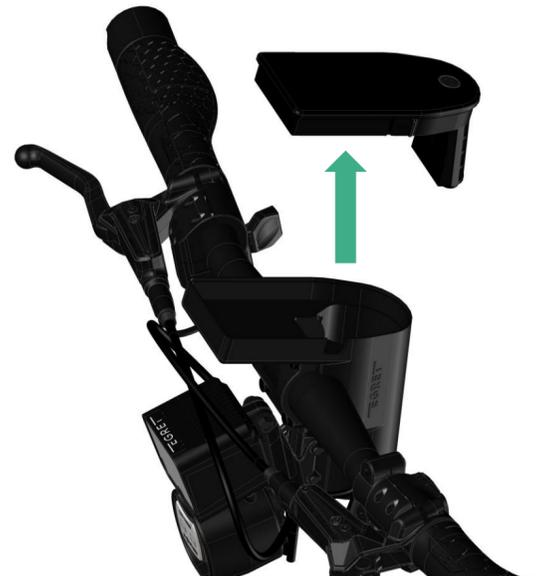
1. Du kannst jetzt das Display vorsichtig vom Lenkkopf abheben. Unter dem Display befinden sich folgende Steckverbindungen (siehe Bild 2):
