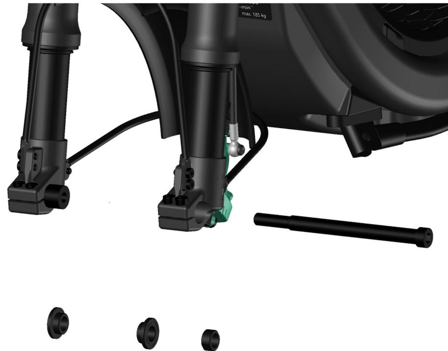
1. Achte beim Ausbau des Vorderrads unbedingt auf die kleinen Distanzscheiben auf beiden Seiten der Radaufnahme.
